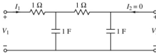
Q4 b) Obtain h parameters in terms of ABCD parameters
